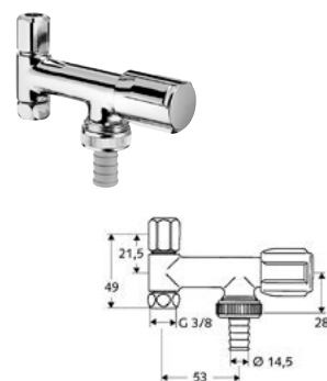
DIANA Nebenanschlußventil/ Geräteventil mit RV 3/8" mit Rückflussverhinderer, und Schlauchverschraubung, Dimension DN 10 G 3/8 IG x DN 10 G 3/8 AG, verchromt, (DI407915500)
