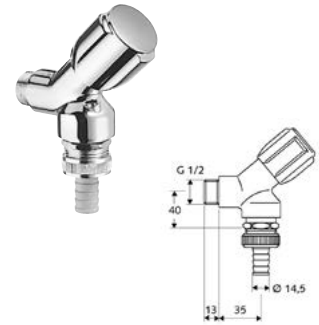
DIANA Geräteschrägsitzventil 1/2" mit RB ohne ASAG Sicherungskombination gem. EN1717 mit Rückflussverhinderer, Belüfter und Schlauchverschraubung, Prüfzeichen P-IX 007/1, DVGW zertifiziert, Dimension DN 15 G 1/2 AG, verchromt, (DI407910500)
