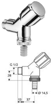
DIANA Geräteschrägsitzventil ohne RB und ASAG mit Rückflussverhinderer und Schlauchverschraubung, Dimension DN 15 G 1/2 AG, verchromt, (DI407911500)
