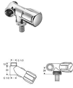
DIANA Nebenanschlußventil mit RV ohne ASAG 1/2" mit Rückflussverhinderer und Schlauchverschraubung, Prüfzeichen PA-IX 2852/II, Dimension DN 15 G 1/2 AG x G 1/2 IG, verchromt, (DI407920500)
